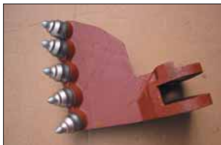
Abb. 7: Räumkettenglied für Bettungsreinigungsmaschine
