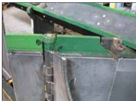
Abb. 5: Hartmetall-Verschleißleiste für Schotterpflüge
