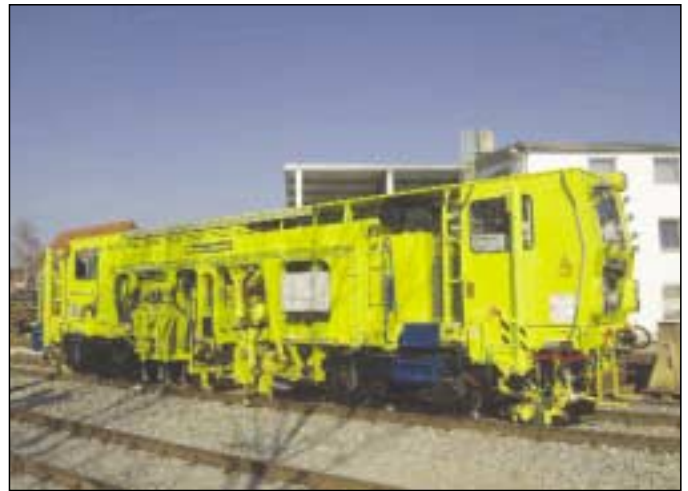
Abb. 4: Universalstopmaschine 08-275/4ZW nach der Reparatur
