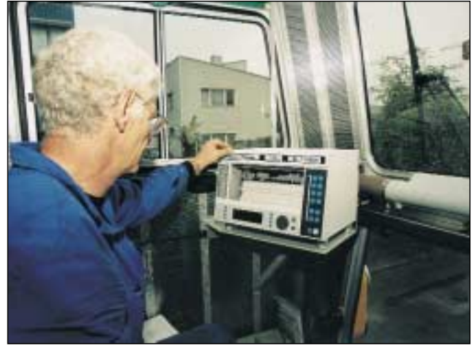
Abb. 6: Justierung einer Messschreiberanlage
