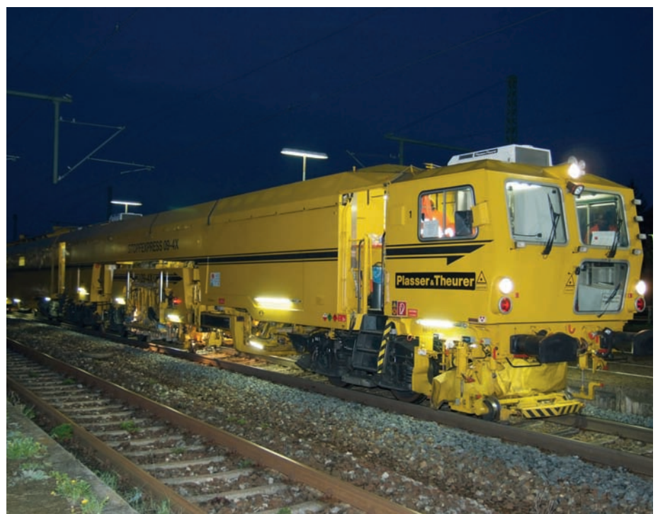
Abb. 2: Kontinuierliche Vier-Schwellen-Stopfmaschine 09-4X
