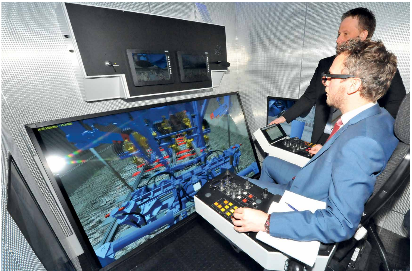
Die vollendet dreidimensionale Darstellung im Simulator Unimat-3D erfordert eine Spezialbrille wie im Kino, hier der Platz des Beistopfers.
